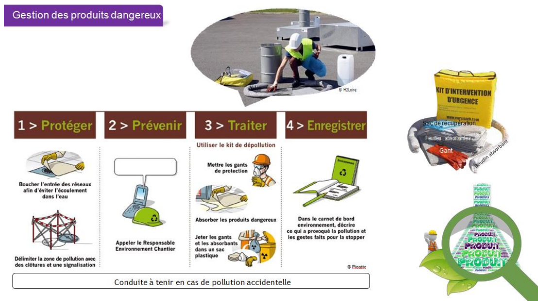
Figure 112. Prévention du risque et stockage de produits dangereux
