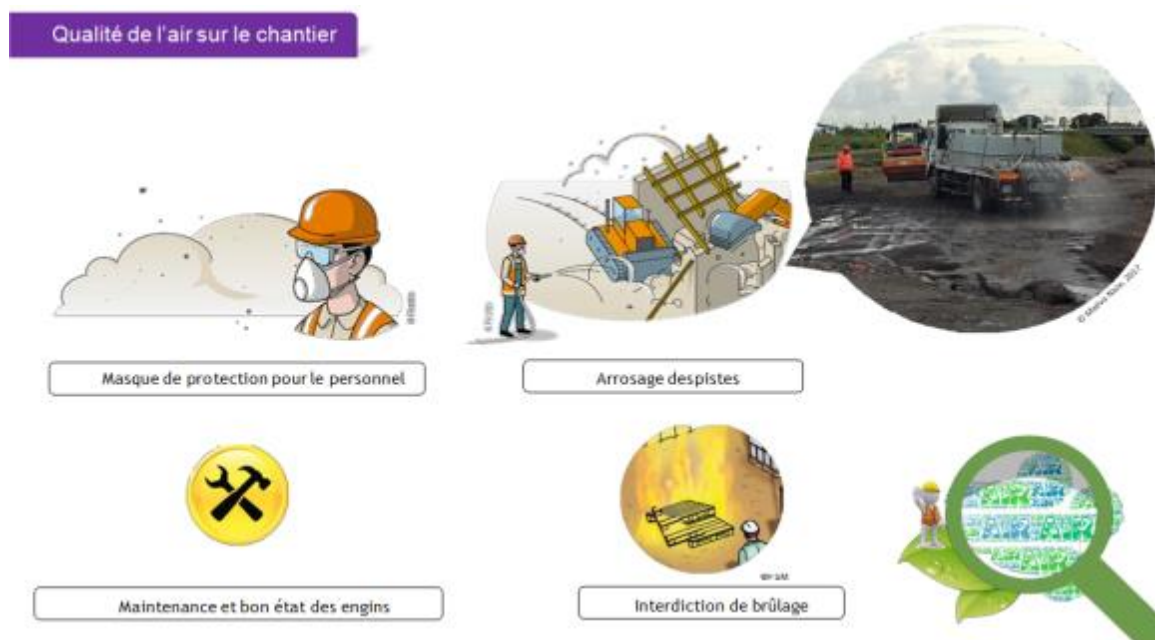
Figure 150 : Exemples de mesures pour limiter l'impact de la phase travaux sur la qualité de l'air
