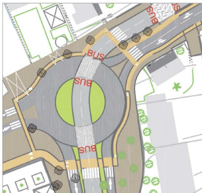
Figure 147 : Cas d'approche d'un giratoire avec site propre
