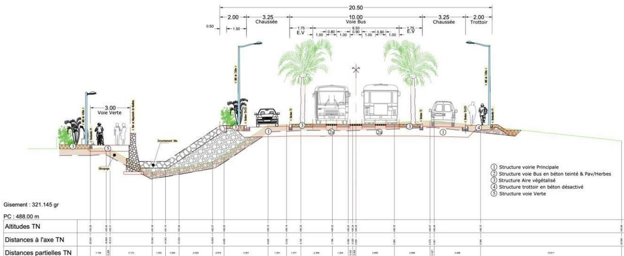
Figure 23 Profil de général avec intégration de la voie verte – tronçon 8
