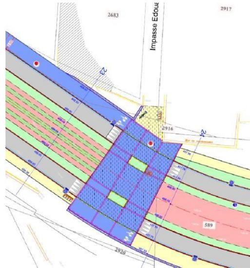
Figure 22 Tronçon 8, plateau de traversé de la voie verte
