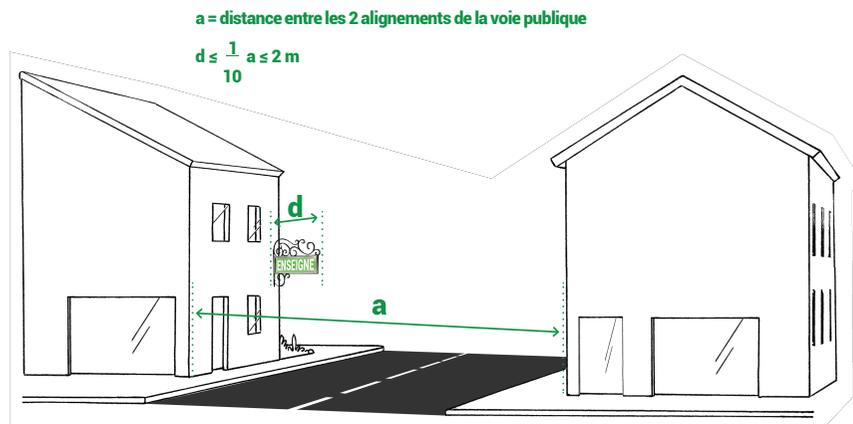
Les enseignes perpendiculaires sont pour la plupart conformes à la réglementation en vigueur. Quelques enseignes dépassent de la limite supérieure du mur ou présente une saillie supérieure à 2 mètres.
