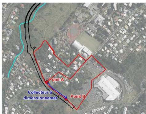
**Il est ainsi proposé de mettre en place une canalisation de DN 800 entre le point A et le point B, avec une pente de 1.5%.**
