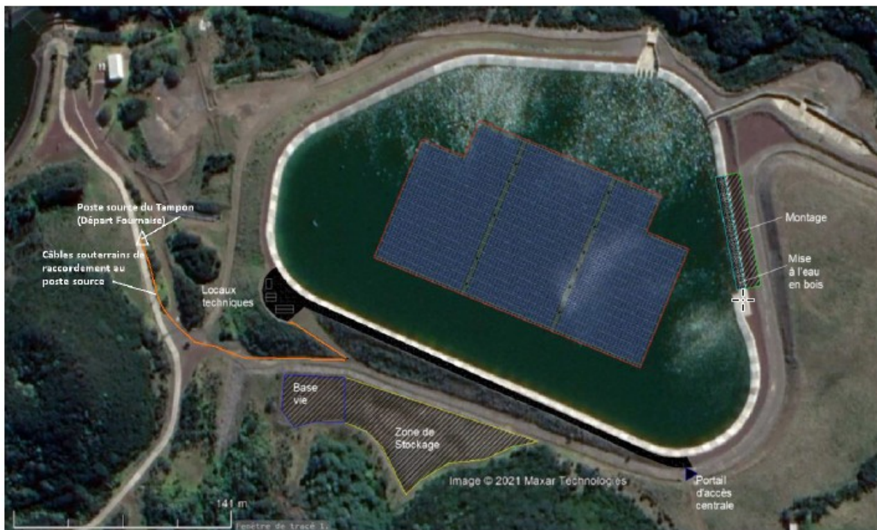
Plan de masse du projet centrale photovoltaïque flottante Piton Marcelin (source : dossier d'étude d'impact page 23)
